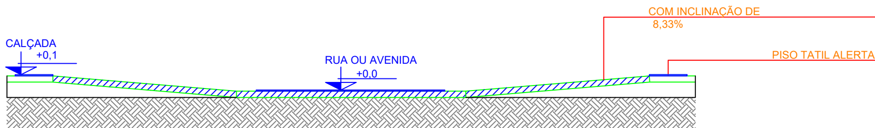
CORTE BB - REBAIXO DO MEIO-FIO
